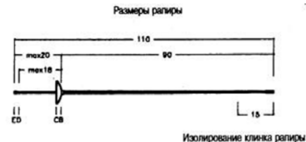
Рисунок 8. Размеры и гибкость рапиры
